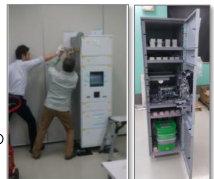
参考：性能試験実施シーン（剛性試験）
