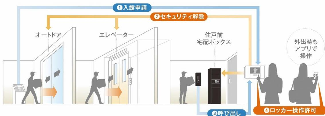
この度、宅配ボックスの利用者のニーズの多様化を受け、フルタイムシステムはアイホンと連携し、より利便性の高いスマートボックスを開発いたしました。インターホンとスマートボックスを連動させ、提携事業者以外の荷物の受取りも可能にいたします。建物内への入館を許可された業者は、住居前に到着した後、再度スマートボックス横のドアホンより入居者を呼び出します。次に入居者は住宅情報盤を操作して業者によるロッカーの開閉を許可することで、スマートボックス内に荷物を置いて帰ってもらえます。
